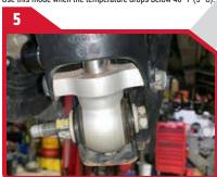
**INSTALL THE LOWER EYELET BY** FOLLOWING THE QUICK START GUIDE.
