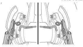
NOTE: DO NOT REMOVE LOCKING PLIERS FROM E-BRAKE EYELETS
