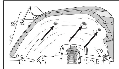
REINSTALL THE 3 FENDER LINER SCREWS (10mm).
