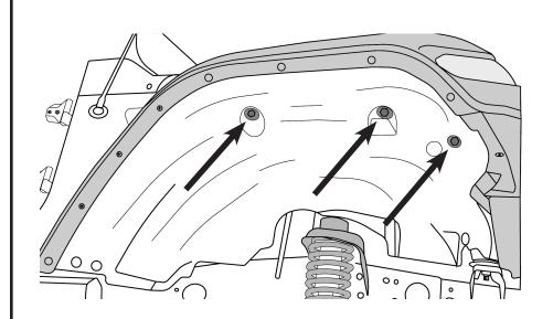
REMOVE THE 3 FENDER LINER SCREWS (10mm).
